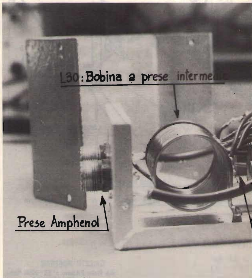
Accordatore d'antenna "ALFA RIGEL" aperto, nel suo contenitore. È chiaramente visibile la bobina L_{30} , il commutatore S_4 e i due variabili d'accordo C_{v31} e C_{v32} .
